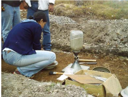
Figura 48. Ensayo compactación (cono y arena).
