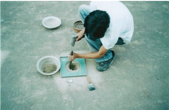
Figura 34. Ensayo de densidad en sitio. Método del cono y arena.
