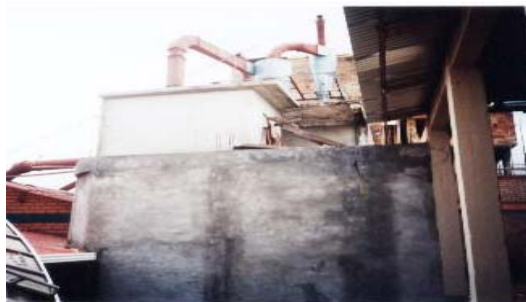
Figura 13. Silo almacenamiento para cisco y polvo
