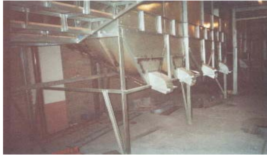
Figura 12. Tolvas ensaque producto final
