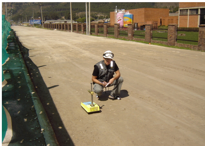
Figura 9. Densidades de campo con densímetro nuclear
