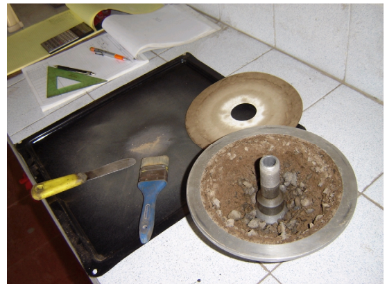
Figura 12. Extracción de asfalto
