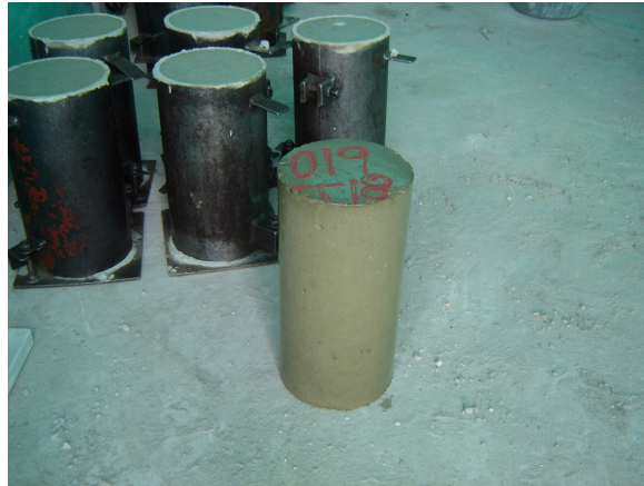
Figura 16 Cilindros de concreto hidráulico
