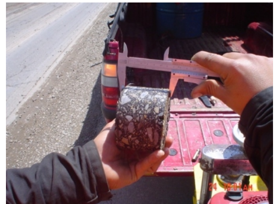
Figura 15 Núcleo de mezcla asfáltica
