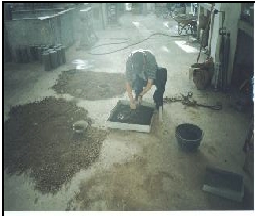
Figura 40. MEZCLA CON AGUA DEL MATERIAL DE ENSAYO
