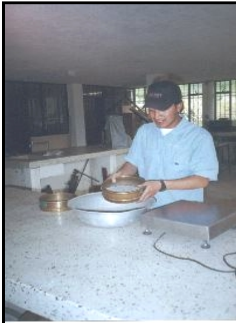
Figura 37. TAMIZADO DE AGREGADO FINO.
