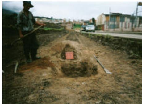
El perfil estratigráfico tomado en un apique de profundidad de 1.50 metros nos muestra una capa vegetal de 40 cm de espesor seguido de una Estrato 1, perteneciente a una Arcilla Gravilosa de baja plasticidad color gris en una capa de espesor de 60 cm y por ultimo un Estrato 2, que corresponde a un Limo de baja compresibilidad color rojizo de espesor 50 cm.
