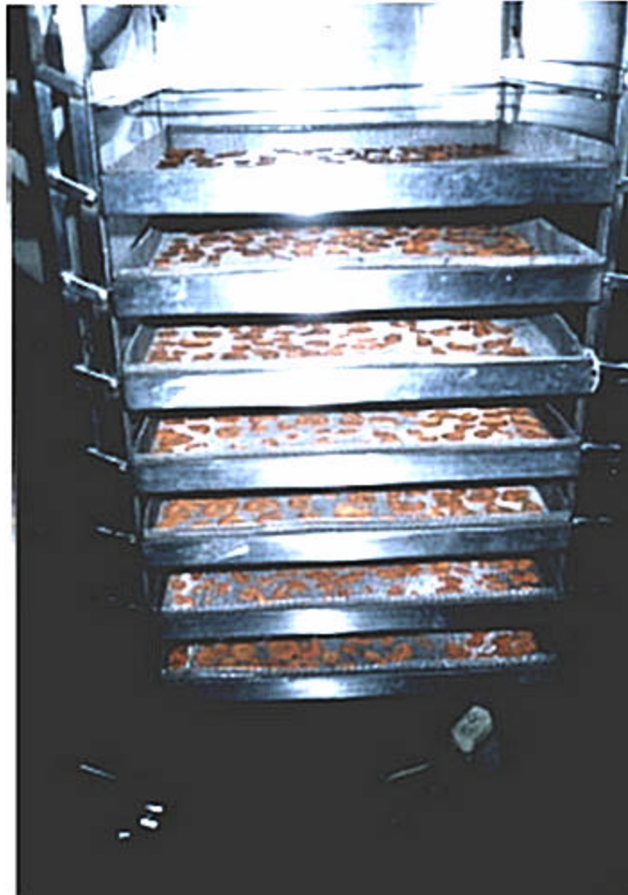
Figura 8. Deshidratación adicional de las muestras en un secador convectivo de bandejas
