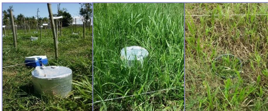
**Imagen 1.** Cámara y base de PVC, (Metodología de Rondón, 2000; Klein y Harvey) para la medición de N<sub>2</sub>O en la Finca agrocomercial del CATIE (Arcos, 2017).
