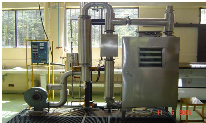
Foto 7. Deshidratadora de la planta piloto Universidad de Nariño
