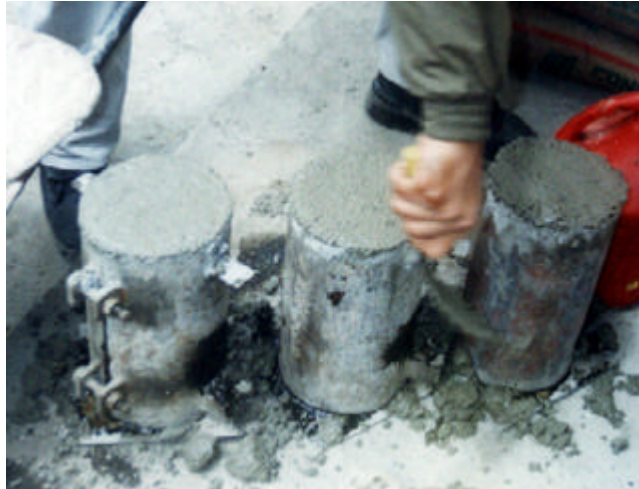
Figura 6. Ensayo “in situ”, slump.
