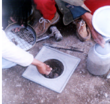
Figura 18.. Pruebas de densidad, cono de arena
