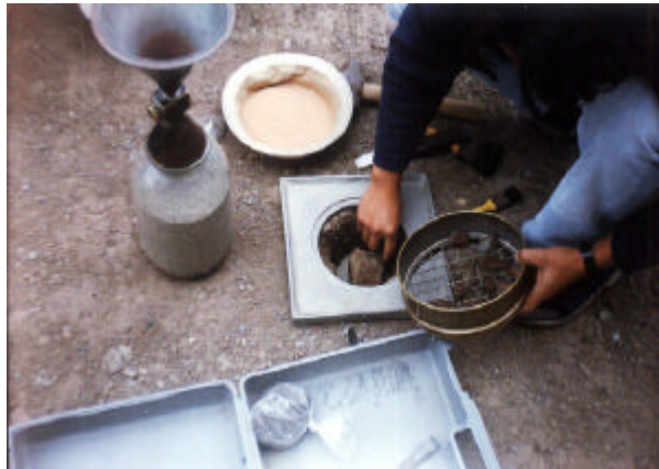
Figura 4 Ensayo de densidad, cono de arena
