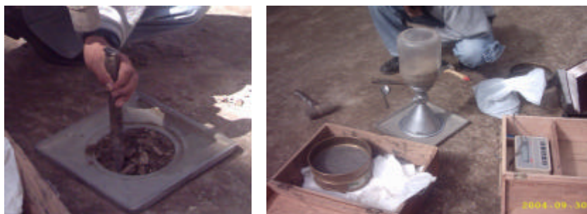
Figura 45. Ensayos de densidad, cono de arena
