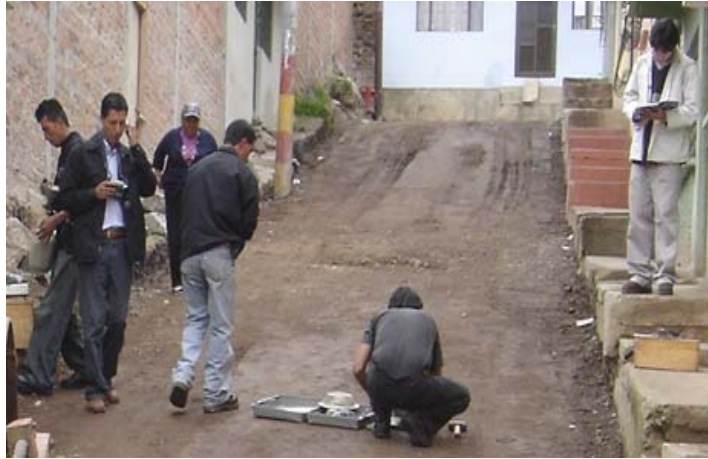
Foto 12. Ensayo de densidad mediante el cono y arena
