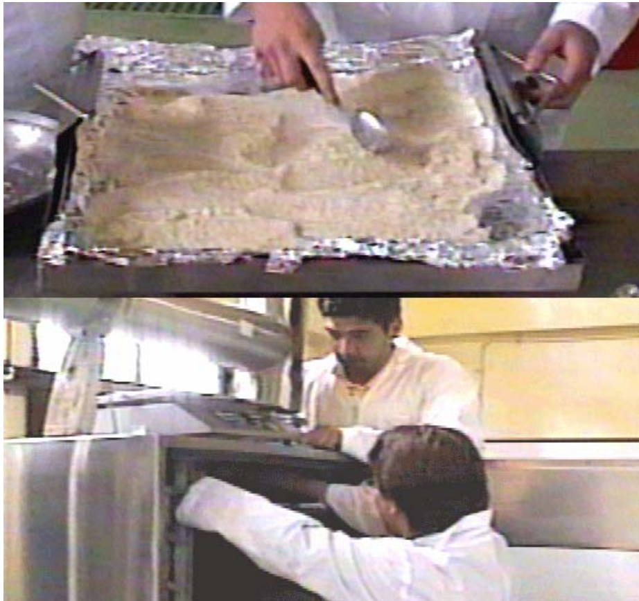
Figura 18. Foto donde se observa la pulpa de papa sobre la bandeja del equipo de secado (imagen superior), Ajustes de la balanza electrónica del equipo antes de iniciar la operación de secado (imagen inferior)
