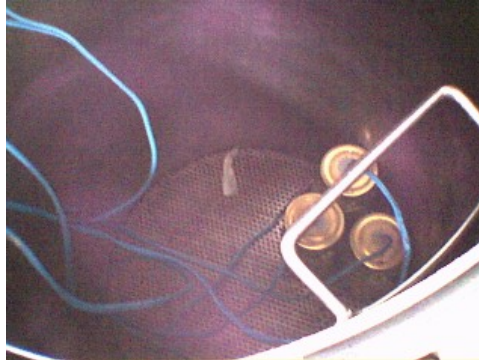
Figura 12. Envases en el calderín para el tratamiento térmico
