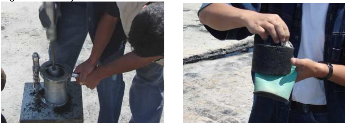
Figura 17. Ensayo del marshall
