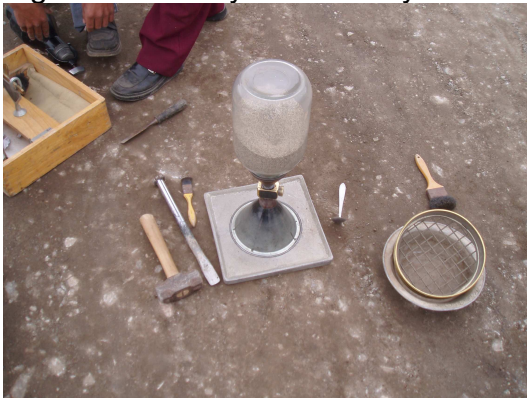
Figura 13. Ensayo del cono y arena
