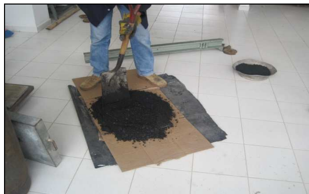
Figura 21. Método de cuarteo
