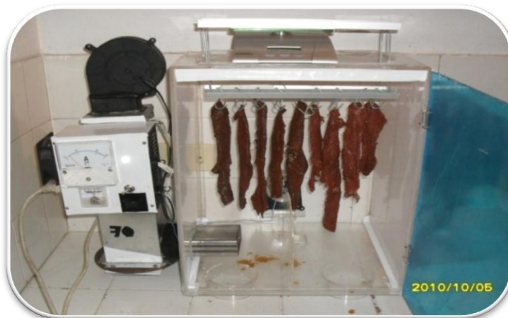
Figura 23. Operación de deshidratación
