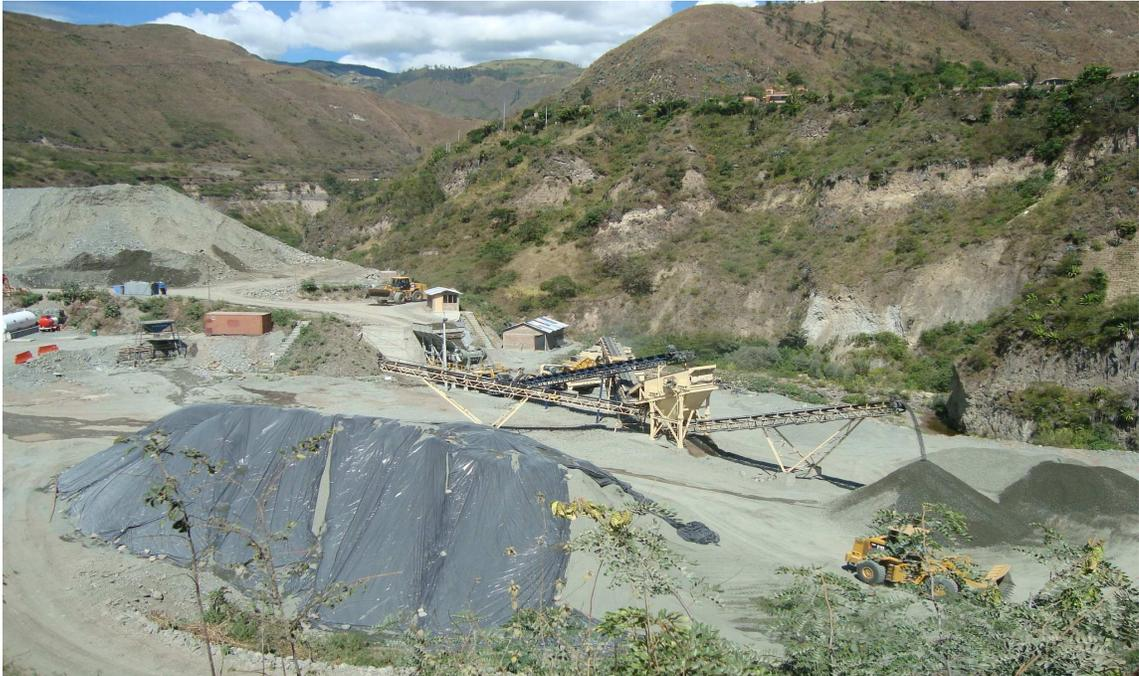
Acopios de reservas de agregado: para producir mezclas asfálticas en caliente de alta calidad es esencial tener buenos procedimientos de acopios de reserva. Los agregados retienen su gradación si son adecuadamente acopiados, mientras que cuando el acopio es malo las partículas de agregado se segregan, y la gradación varía en los diferentes niveles del acopio.
