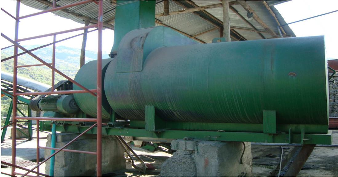
Temperatura de la mezcla: tanto el asfalto como el agregado deben ser calentados antes de ser combinados en el mezclador; el asfalto para darle suficiente fluidez y pueda ser bombeado, y el agregado, para que esté lo suficientemente seco y caliente, para que así se produzca una mezcla a la temperatura deseada.
