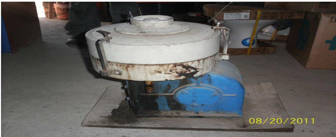
**Foto No.33. Centrifuga mecánica para extracción de asfalto laboratorios planta en estudio**
