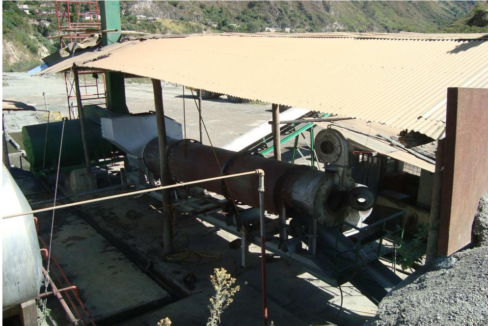
Exigencias que debe cumplir el secador: el horno secador estará diseñado con una longitud y un número de revoluciones tales que permitan recibir los agregados y movilizarlos hacia la salida en una forma regular y continua.
