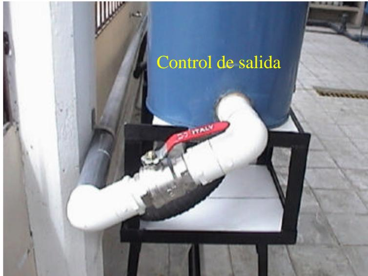
Los materiales a evaluar elegidos son los mas comúnmente utilizados en redes hidráulicas como el PVC, el Hierro Galvanizado y el Acero Inoxidable, al igual que los aditamentos, válvulas de bola y compuerta, codos, tees y reducciones.
