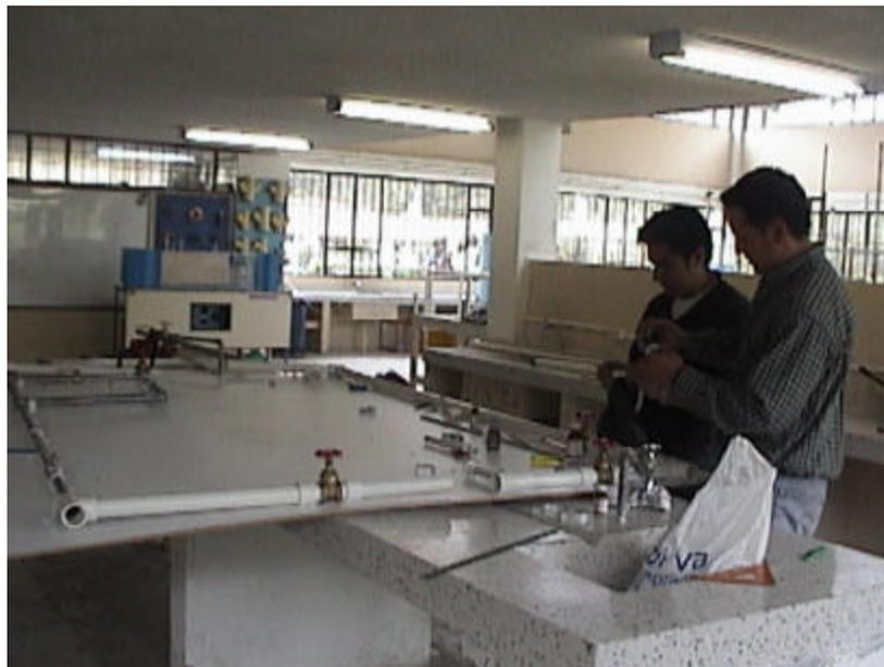
Para el tramo de PVC  $\frac{1}{2}$ " se cortan 3 niples de PVC de  $\frac{1}{2}$ " con una longitud de 16cm, incluyendo la distancia de lectura.
