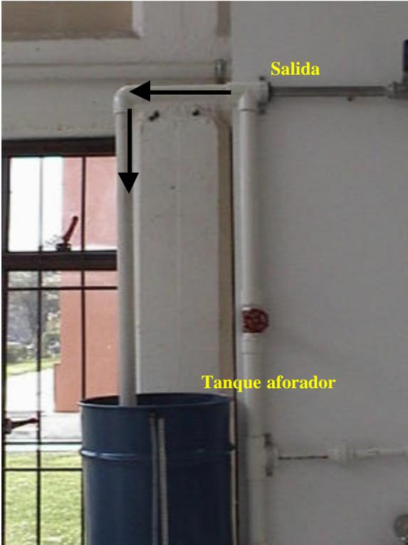
Finalmente una vez se haya tomado el tiempo para la determinación del caudal debe abrirse la válvula de salida del tanque de aforo con el fin que el agua retorne nuevamente al tanque principal.
