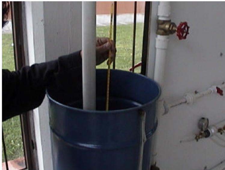
☛ Abra la válvula de salida del tanque aforador
