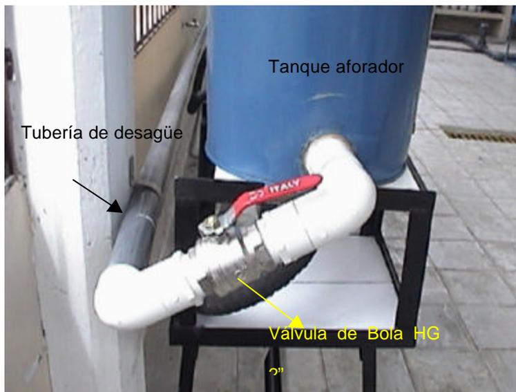
El equipo se lo montó sobre una estructura en ángulo  $1 \frac{1}{2}$  la cual fue pintada con anticorrosivo y luego pintura negra para darle un acabado acorde a los demás equipos del laboratorio, esta estructura fue empotrada a una de las vigas que forman uno de los pórticos del laboratorio de Hidráulica.
