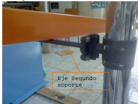
Figura 29 Segundo soporte de la Viga-Canal
