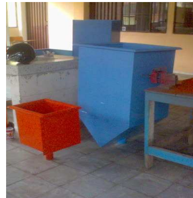
Figura 52 Tanque externo y cámara de descarga
