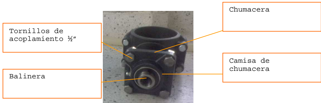
Figura 27 Soporte del la viga-canal
