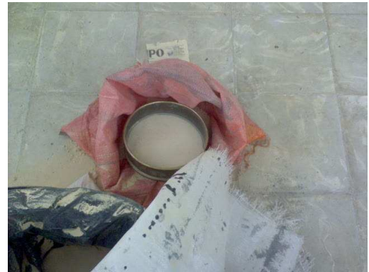
Figura 83 Tamizado del arcilla
