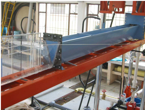
Figura 71 Empate canal metálico T.
