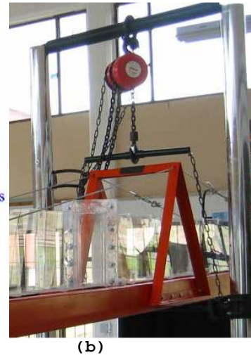
Figura 59 Sistema de acenso del canal: (a) Diagrama explicativo, (b) sistema real.
