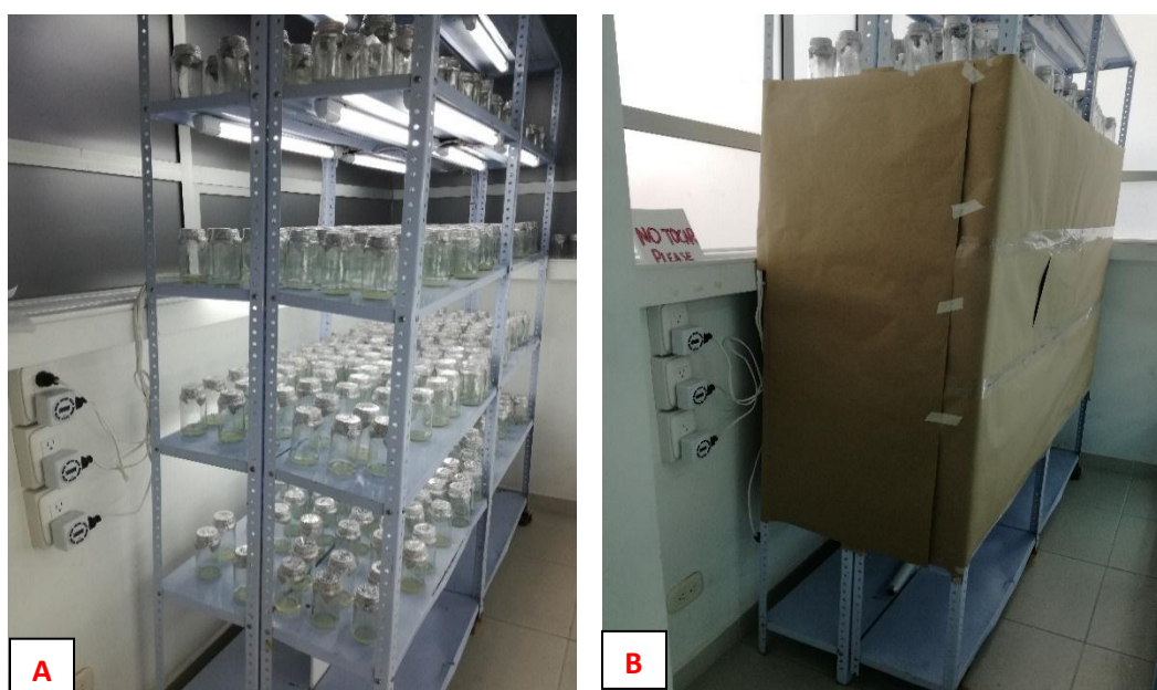
Fotografía 2. A: Disposición de tratamientos en estantería metálica y temporizadores digitales. B: cubierta de tratamientos e inducción de fotoperiodos.
