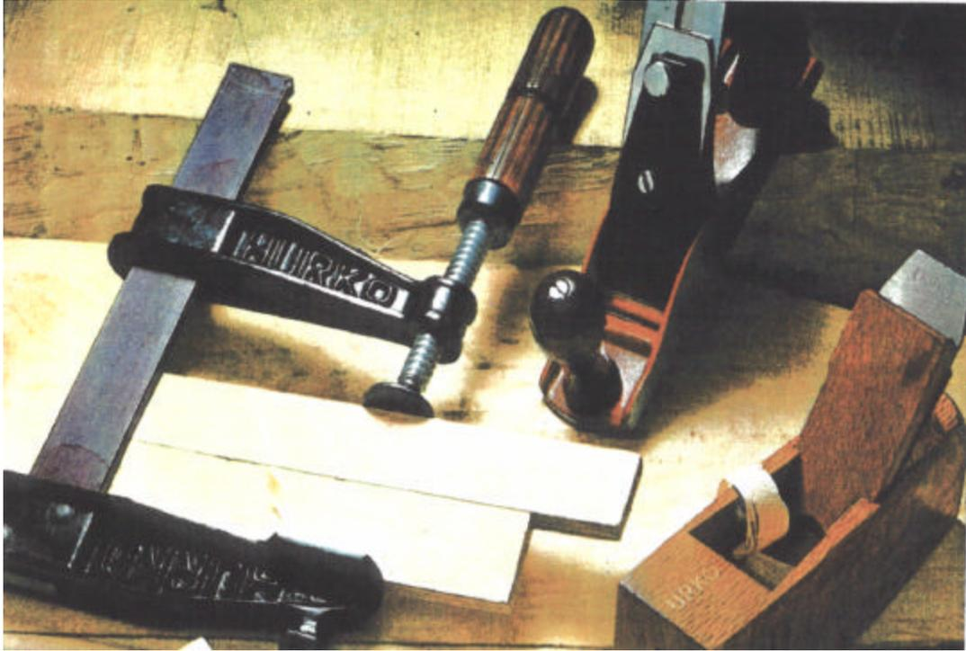
Los cepillos se utilizan para suavizar y dar forma. Consisten en una hoja o cuchilla afilada de acero encajada en un soporte metálico o de madera, dispuesta en ángulo con respecto a la superficie a alisar. La profundidad de corte se regula ajustando la distancia que sobresale la cuchilla respecto a la base del cepillo. Hay cepillos de muchos tamaños, incluso unos especiales que se usan para hacer surcos. También se utilizan varios tipos de lima para alisar y dar forma a la madera.
