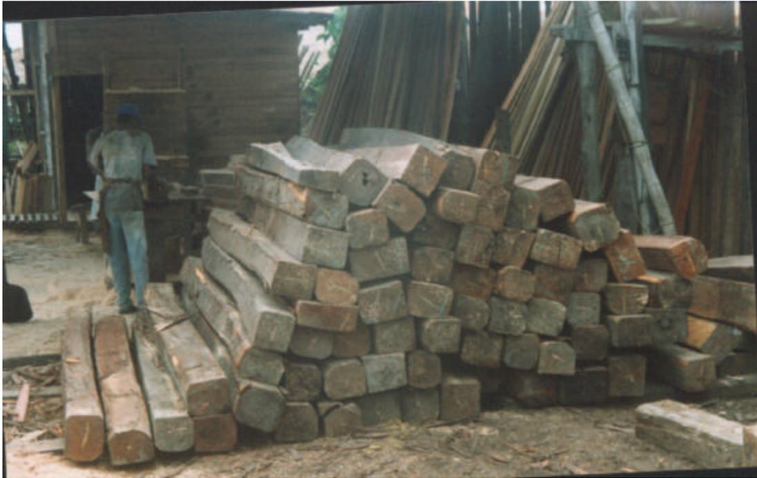
El aserrado de la madera consiste en la obtención de piezas por el corte de las trozas producidas por los árboles, estas piezas que se transforman en bloques, tablones o tablas según su espesor, son utilizadas como materia prima en la construcción de viviendas, en las construcciones de ferroconcreto, en la producción de muebles y otras actividades.
