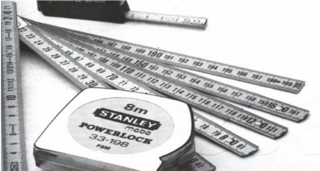
También se utilizan herramientas para medir y comprobar los tamaños y la alineación de los elementos. Estas herramientas son, entre otras, la cinta métrica, el metro plegable y la regla metálica. La escuadra se utiliza para comprobar ángulos rectos, y el nivel para comprobar la alineación horizontal y vertical. En los trabajos en los que hay que pegar las piezas, éstas se sujetan con abrazaderas y cárceles (también llamadas gatos).
