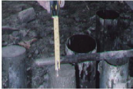
FIGURA 11 PRUEBA DE CONO DE SLUMP
