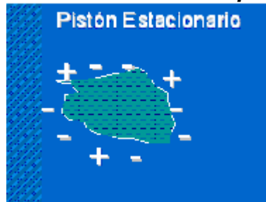
Figura 4. Partícula cargada eléctricamente dentro del pistón
