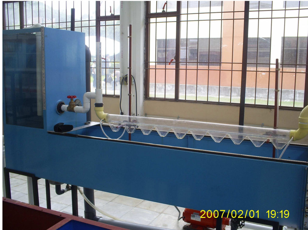
Figura 4.1. Instalación y sedimentador
