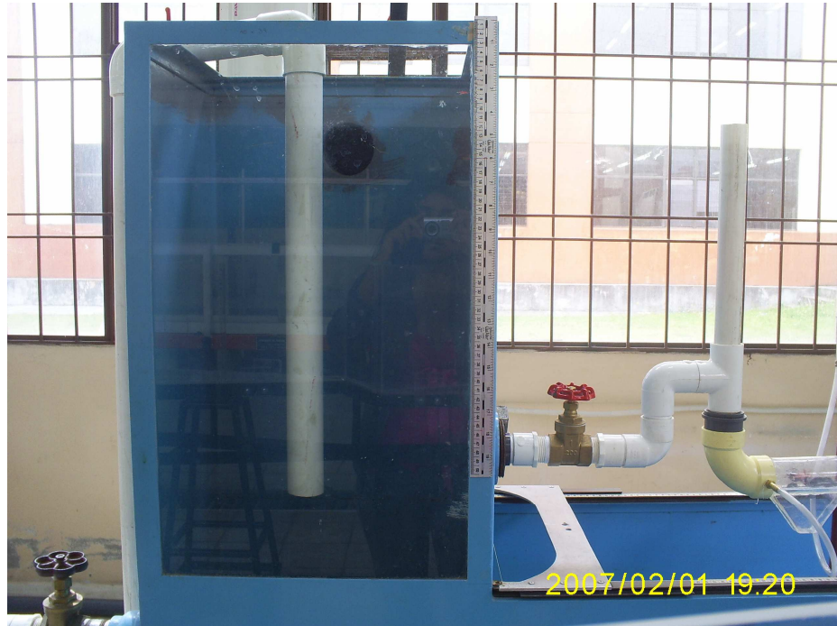
Figura 4.2. Tanque de suministro y entrada al sedimentador
