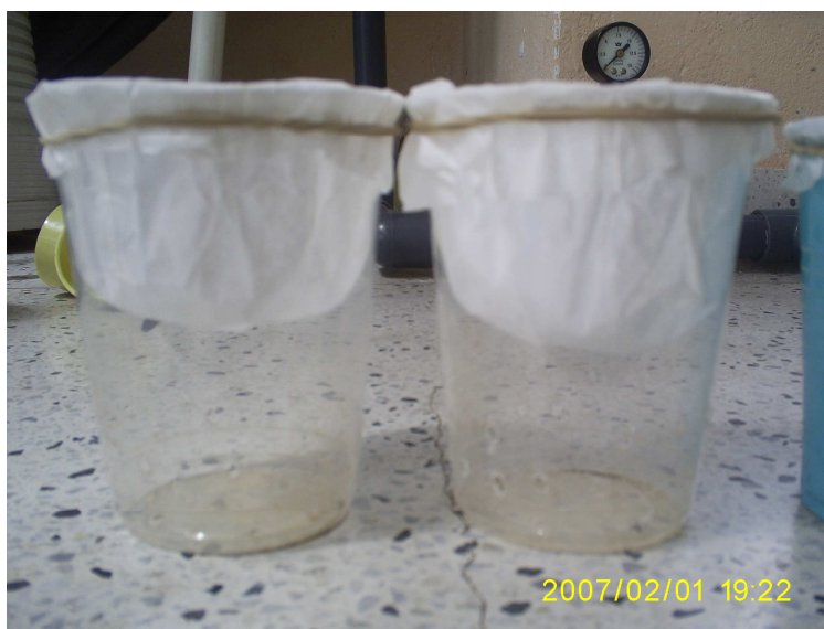
Figura 4.5. Filtros para la recolección de sedimentos
