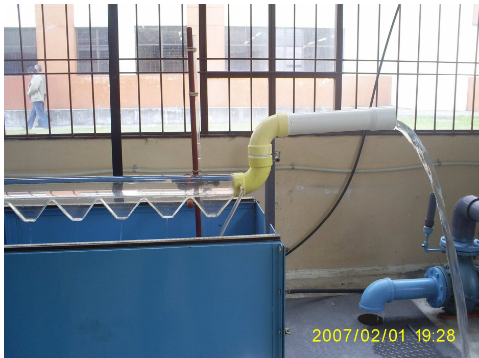
Figura 4.3. Caudal líquido de salida estabilizado
