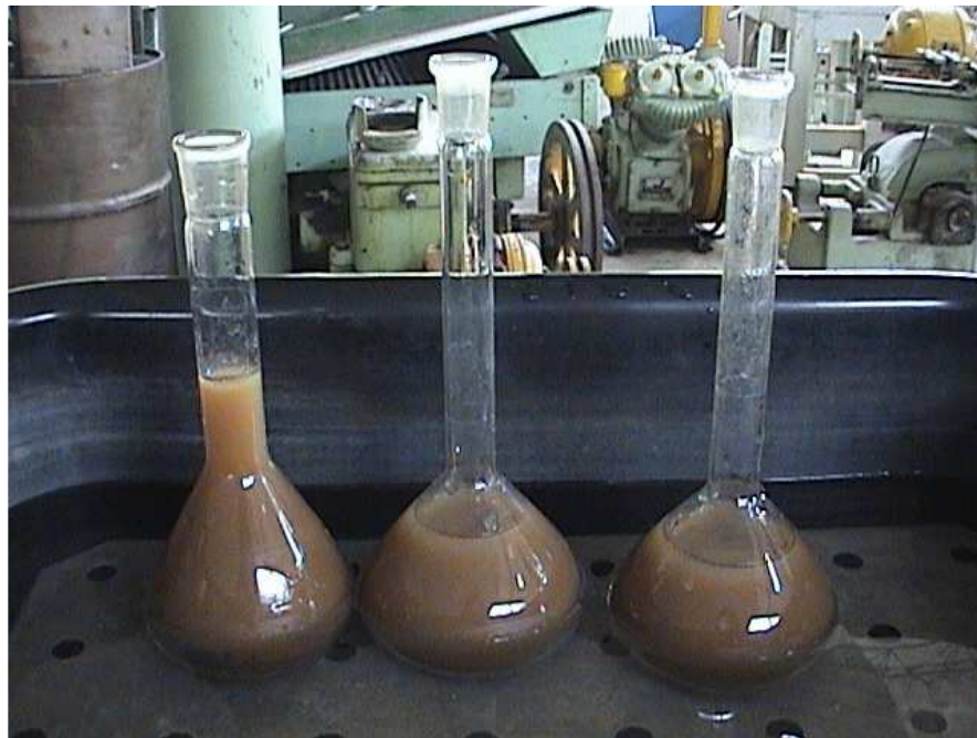
Figura 3.1 Fotografía de la elaboración del ensayo de gravedad específica
