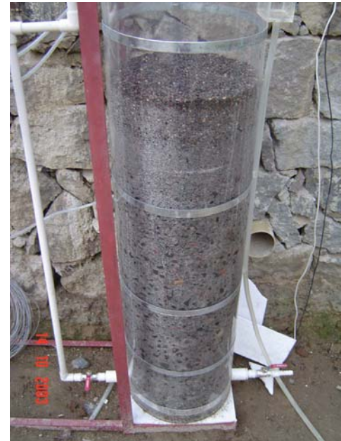
Figura 4. Estratos filtrantes de grava en el FGAs
