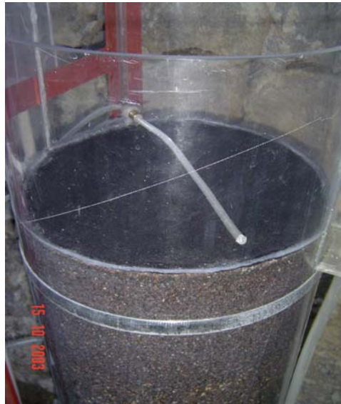
Figura 5. Disposición del geotextil NT – 2.000 en el FGAs
