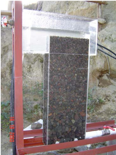
Figura 3. Estratos filtrantes de grava en el FGD i
