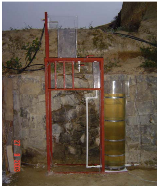
Figura 2. Filtro piloto (estructura en acrílico, andamio y tubería).
