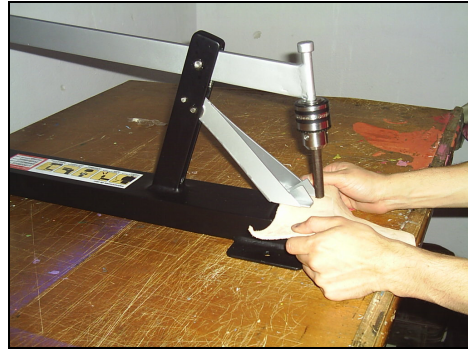
Figura 39. Introducir y ubicar el cuero debajo de la guía.
