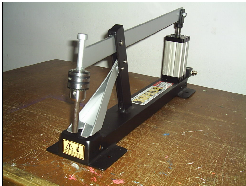
Figura 33. Sistema neumático para el repujado de cuero a partir de labores.
