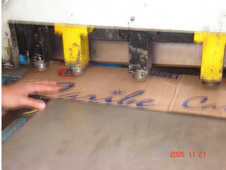
Figura 65. Corte con cizalla hidráulica.
