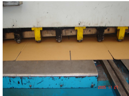
Figura 30. Corte con Cizalla Hidráulica.
