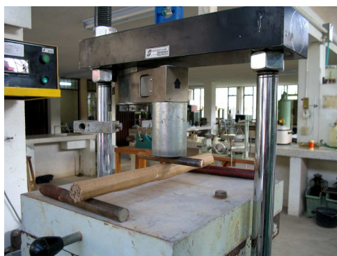
Figura 25. Pruebas Físicas (Tensión rollos).
