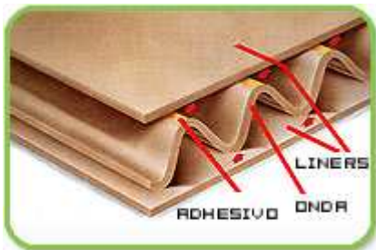
Figura 1: Esquema Cartón Corrugado.
