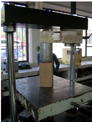
Figura 27. Pruebas Físicas (Compresión bloques).
