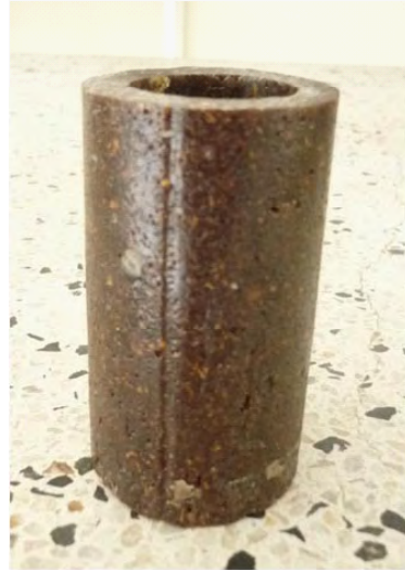
Figura 64. contenedor hecho con el composite
