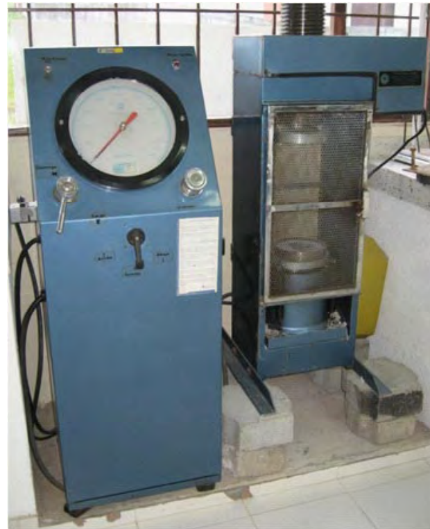
Figura 50. Máquina para pruebas de compresión
