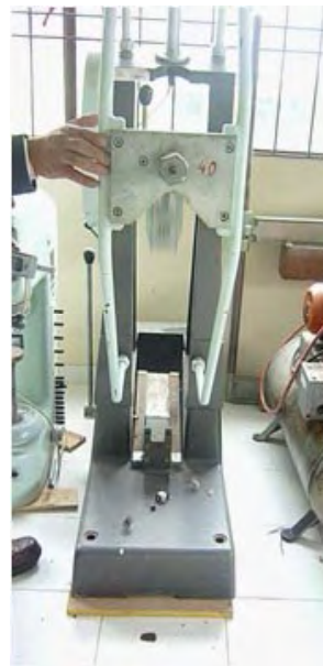
Figura 56. Maquina para prueba al impacto
