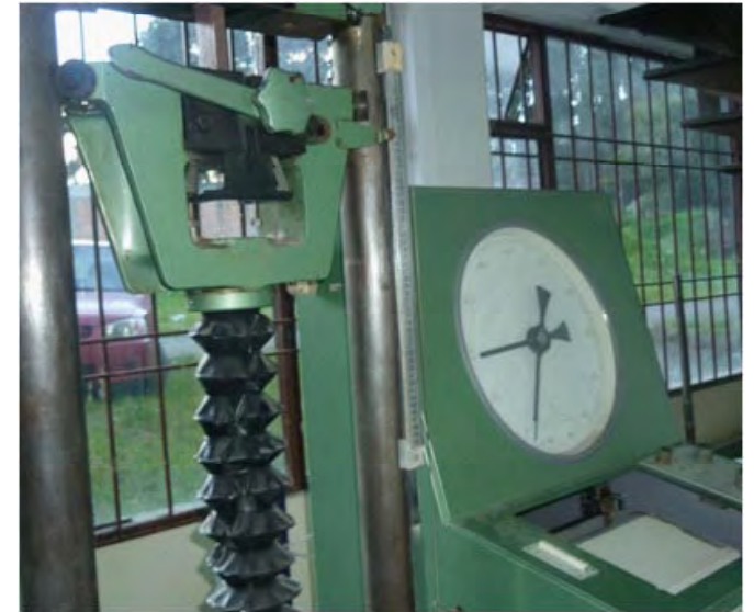
Figura 54. Maquina para pruebas de tensión.
