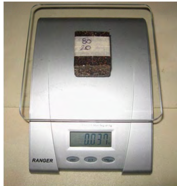
Figura 62. Obtención del peso para una probeta cortada, usando una balanza electrónica
