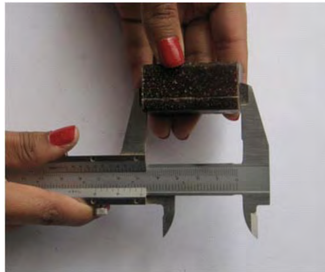
Figura 48. Medición de las probetas para compresión
