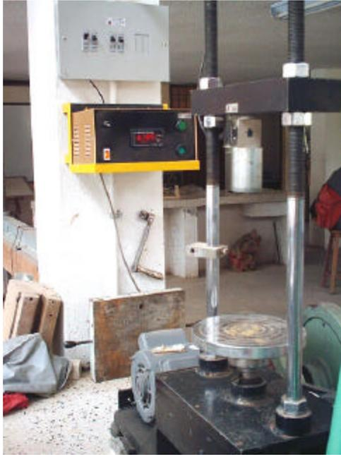
Figura 39. Compresión de pieza 1
