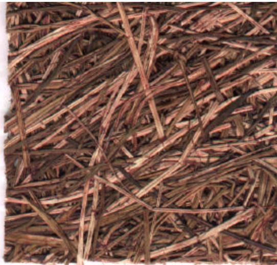
Con el fique se obtiene mejores resultados en cuanto a impregnación y resistencia, por ser una fibra mas delgada permite que haya mas fibras por centímetro cuadrado, lo que se traduce en rigidez de la pieza; esta puede ser maquinada con herramientas como sierra sin fin, sierra circular taladro, ruteadora.
