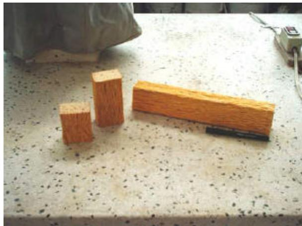
2. Se realizo primero el ensayo de compresión colocando la pieza de 12 cm de alto en el equipo, con el contador en cero se procede a romper la pieza. El contador indico que la pieza se rompió a las 6577 libras.
