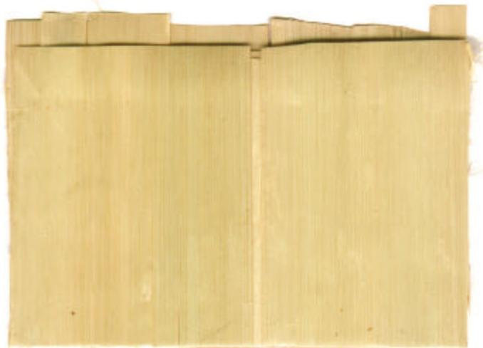
El fique tizado al igual que la tetera es muy fácil de trabajar pero se corre el riesgo de que la fibra no quede muy bien impregnada, y si se aplica resina en exceso la pieza puede presentar secciones blancas debido a la acumulación de esta.
