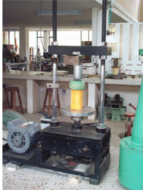
3. Como segundo ensayo se rompió la pieza de 8 cm de alto con un resultado de 6177 libras.
