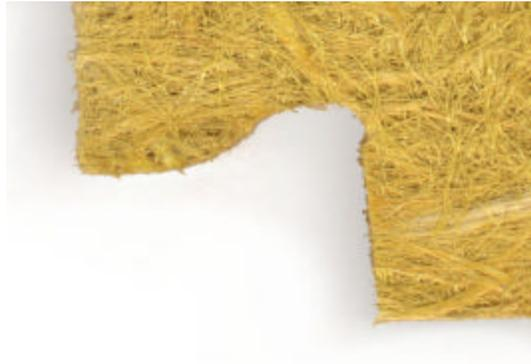
Con la iraca no se obtiene tanta rigidez como con el fique debido a la estructura de su fibra (enrollada); con los residuos de la producción de sombreros es posible pero se requiere ejercer una presión mucho mayor que para hacer una pieza de características similares a las de una de fique
