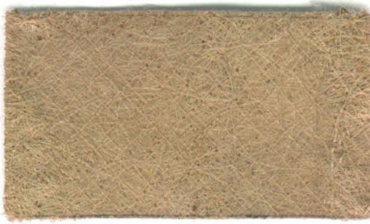
Para realizar piezas de residuos de iraca es necesario picar la fibra para facilitar la impregnación de la resina y el prensado, de lo contrario se hace muy trabajoso y el tablero queda de muy baja densidad.
