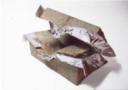
3. Se desmolda y se retira la rebaba con una herramienta de corte
