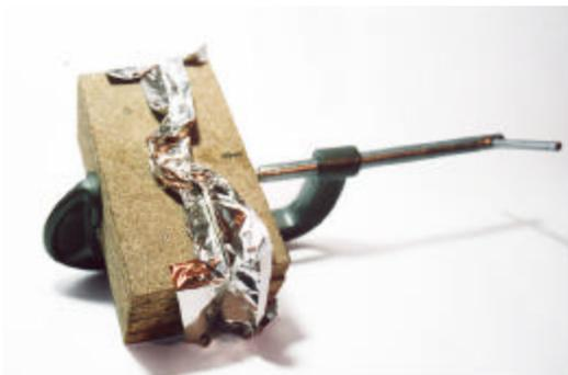
2. La fibra es prensada por medio de una prensa manual
