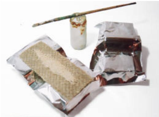
1. Se impregna la fibra con la resina, el molde se recubre con aluminio
