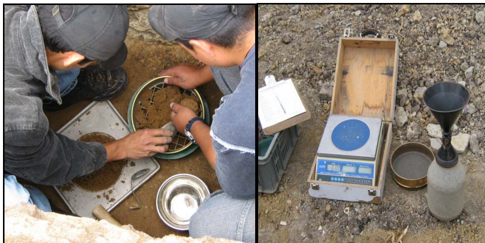
FIGURA 63.- Toma de muestras y equipo para toma de densidades.
