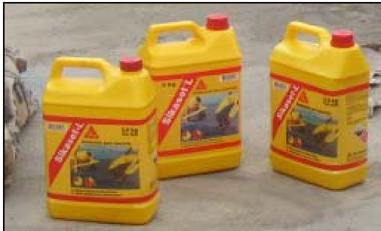
FIGURA 68.- Acelerante a siete días utilizado en la mezcla
