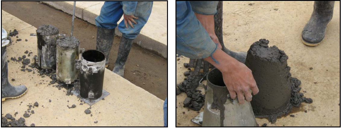
FIGURA 67.- Toma de cilindros de muestra para prueba de resistencia y medida de asentamiento.
