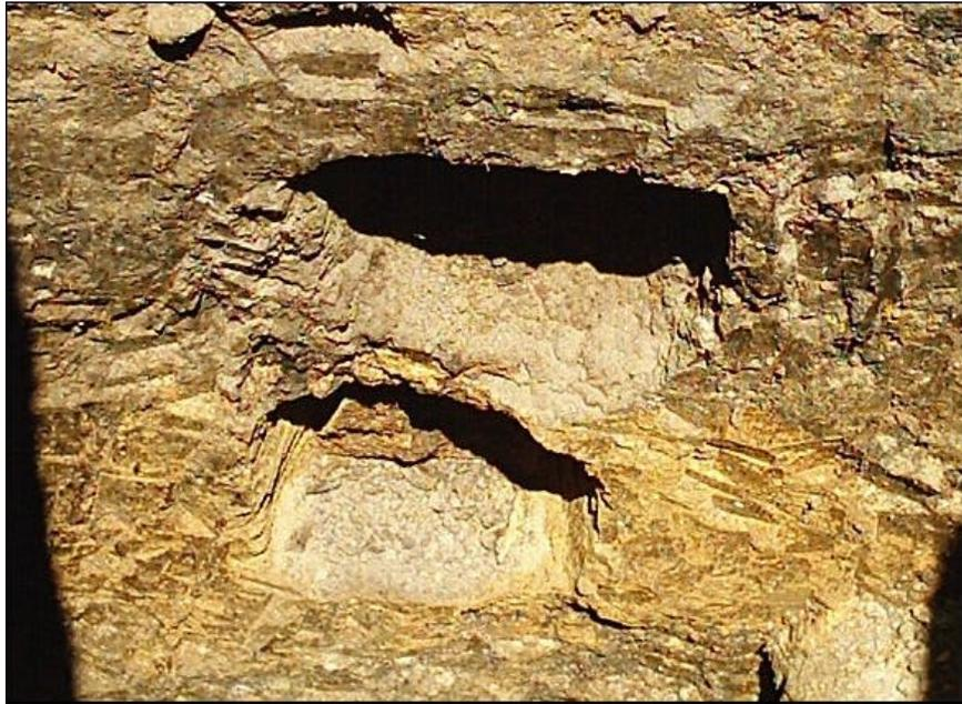
**Figura 6: Moldeo de muestras inalteradas para el ensayo de compresión inconfiada**
