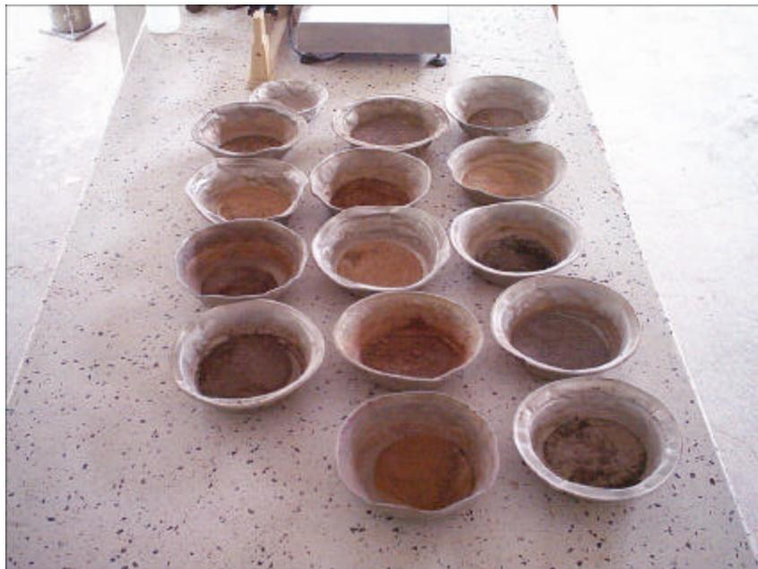
**Figura 11: Secado al aire para realizar limite liquido y plástico**
