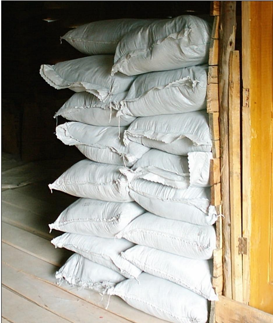
**Figura 82: Plastificante Sikament N-100, empleado para hacer manejable la mezcla de concreto con Sikafume**
