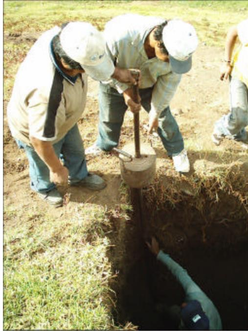
**Figura 26: Detalle del equipo de Penetración Estándar**
