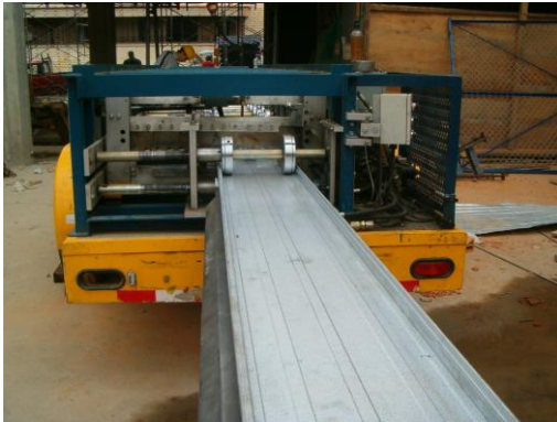
Figura 140. Máquina curvadora de tejas en aluzinc luxalon.
