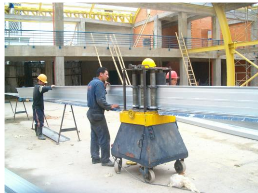
Figura 140. Máquina curvadora de tejas en aluzinc luxalon.
