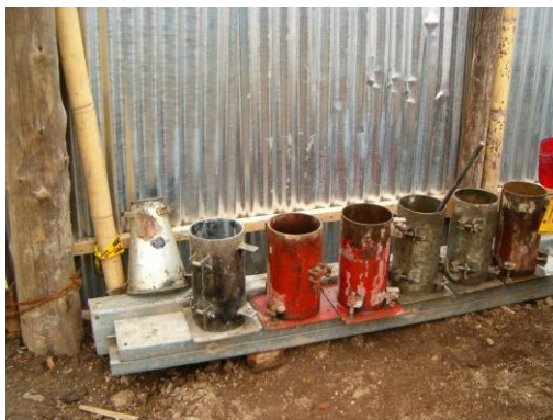
Figura 2. Toma de muestras de concreto.
