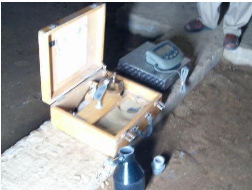
Figura 85. Ensayo con el Speedy para ver la humedad del material de base, y toma de densidades parquadero. (Ver anexo G )
