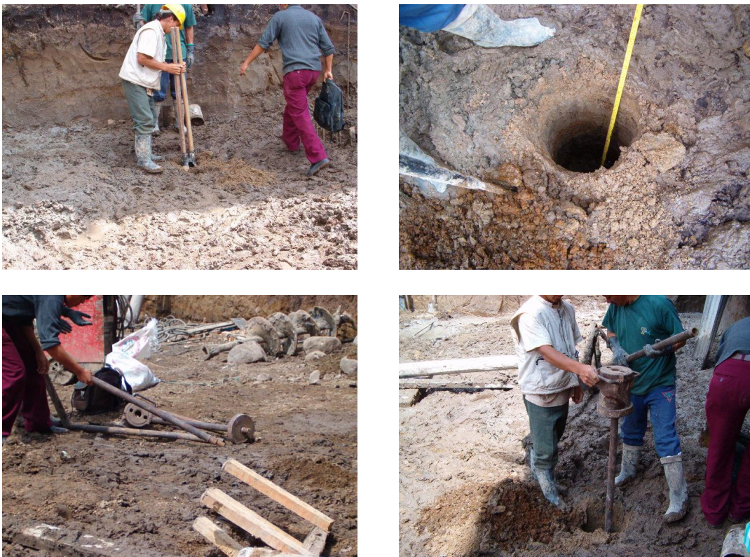
Figura 3. Estudio de suelo tomado al eje 5.
