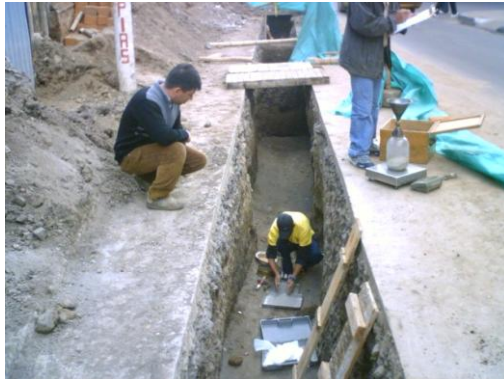
Figura 1. Control de toma de densidades “in situ”.
