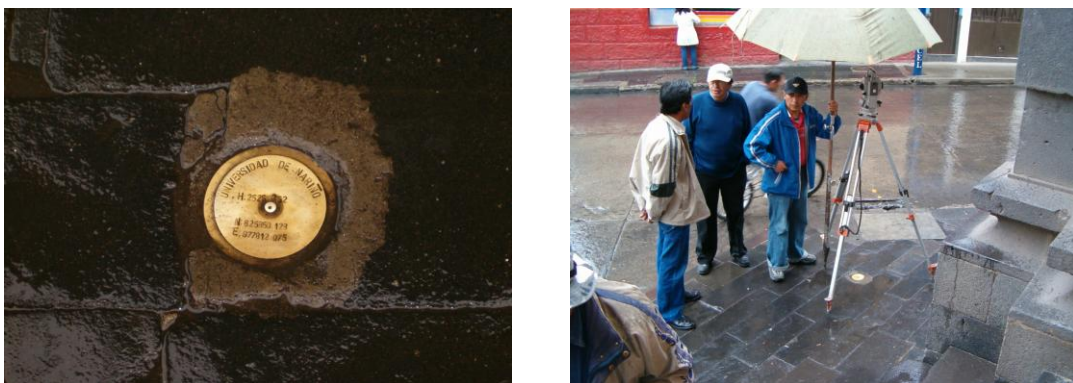
Figura 14. Levantamiento topográfico amarre punto geodésico
