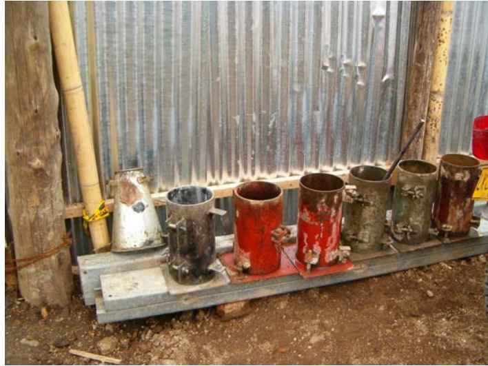
Figura 17. Cono de Abraham y cilindros.
