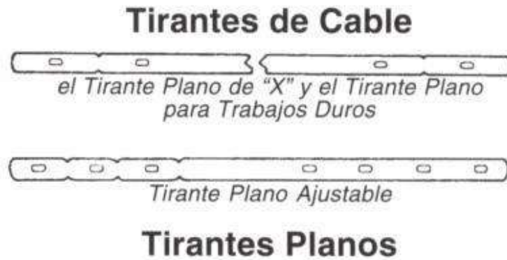
Figura 8. Esquema de tirantes planos x. Sistema Symons.
