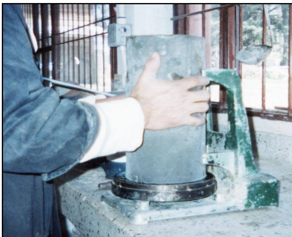
Recubrimiento de los cilindros de prueba
