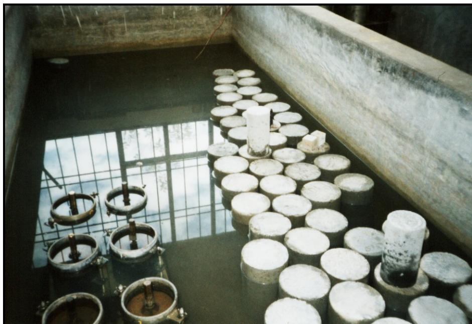
Curado concreto cilindros de prueba
