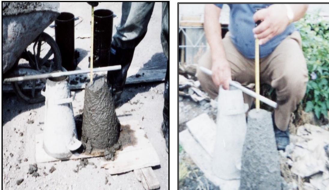
Control de consistencia de la mezcla, asentamiento por Cono de Abrams
