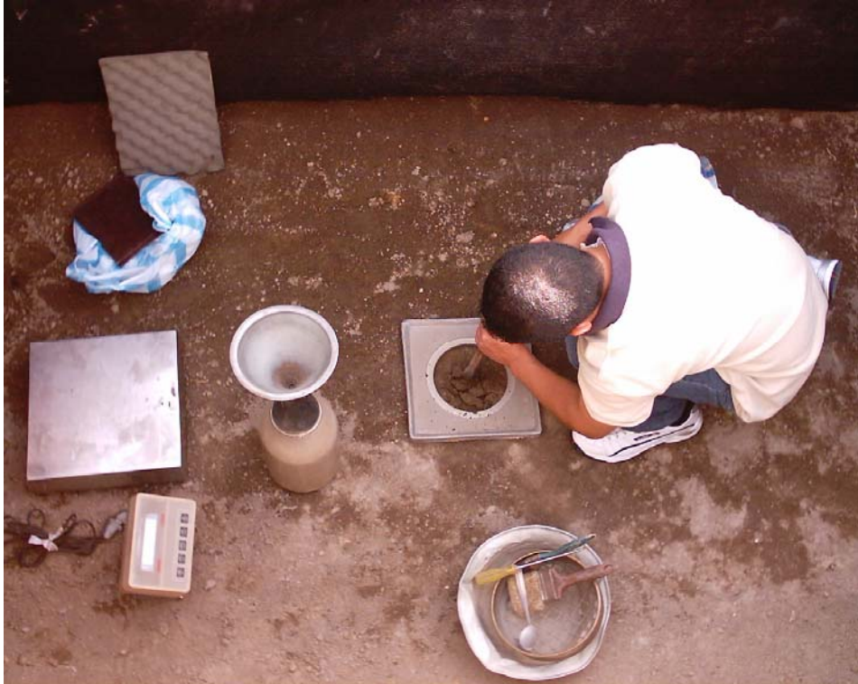
Figura 62. Ensayo de densidad con cono y arena zapata 5d
