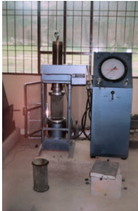
Figura 3. Ensayo de compresión axial de cilindro de concreto
