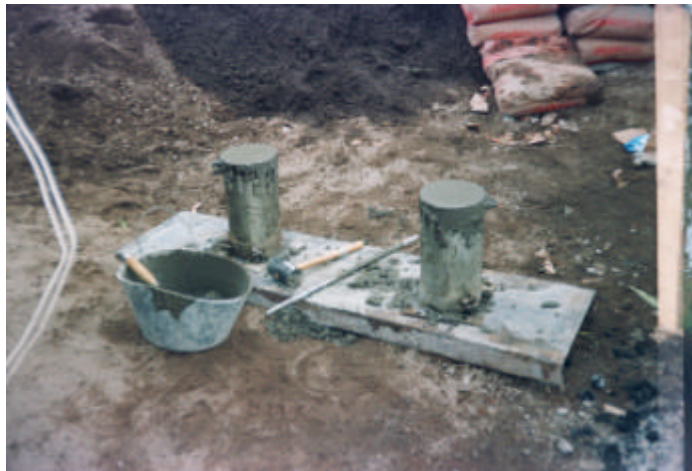
Figura 2. Elaboración de cilindros para el ensayo de compresión axial
