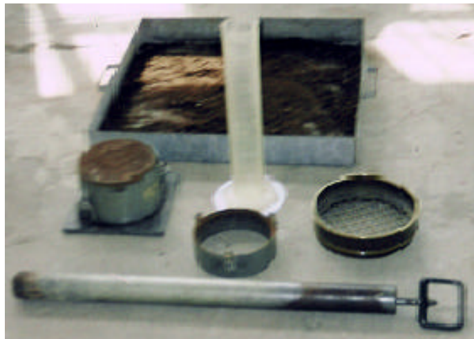
Figura 8. Ensayo de compresión “Proctor Modificado”
