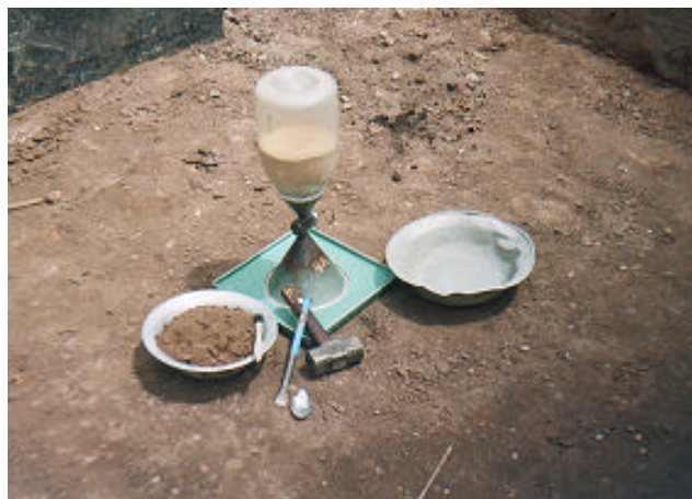
Figura 10. Ensayo del cono y la arena
