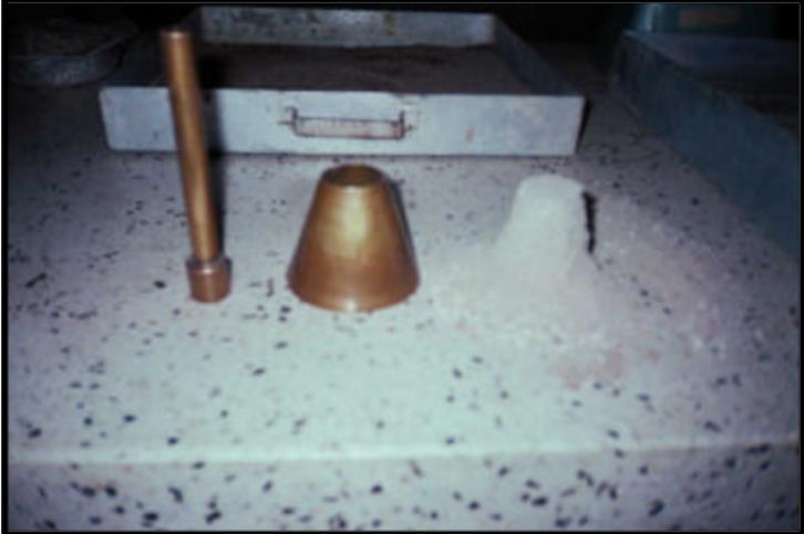
**Figura 15. PESO ESPECIFICO AGREGADO FINO**
