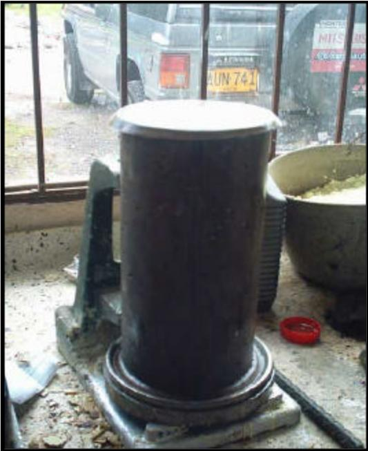
**FIG 27. ENSAYO DE RESISTENCIA Y COMPRESION DE CILINDROS NORMALES SEGÚN NORMA ICONTEC 673**
