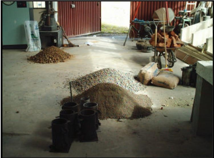
**Figura 24. TOMA DE CILINDROS DE CONCRETO PARA CONTROL DE LA RESISTENCIA NORMA ICONTEC 550**
