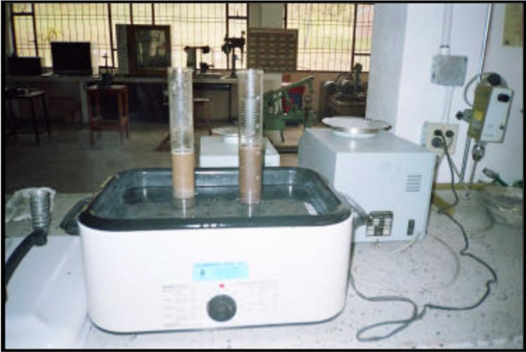
**Figura 16. PESO ESPECIFICO AGREGADO GRUESO**
