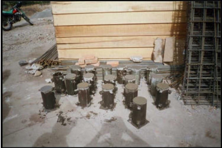
**Figura 25. CURADO DE CILINDROS NORMA ICONTEC 1377**
