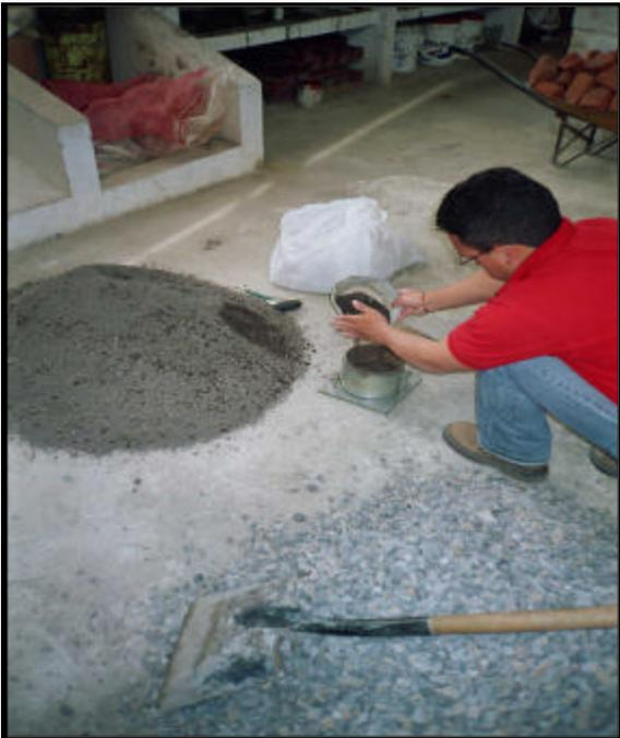
**Figura 14. ENSAYO CONDICION SATURADA SUPERFICIALMETE SECA DE GREGADO FINO**
