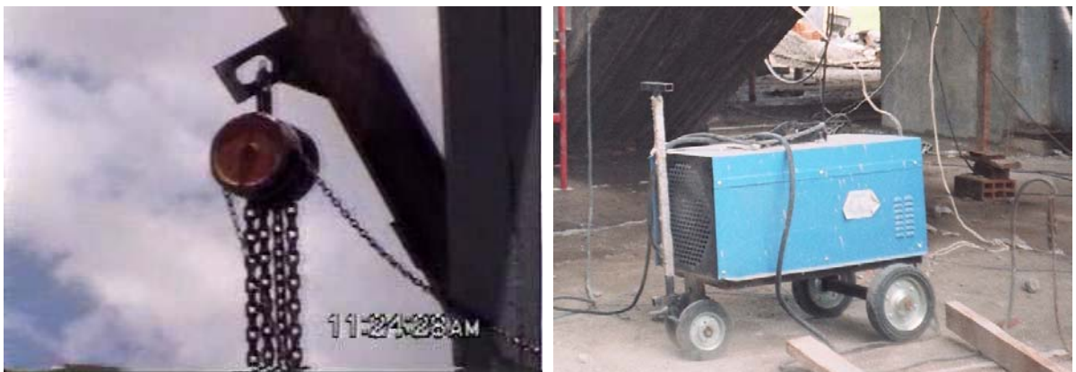
Figura 50. Diferencial mecánico y Soldador eléctrico para electrodo.
