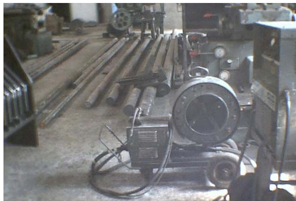
Figura 48. Equipo de aplicación de Soldadura MIC
