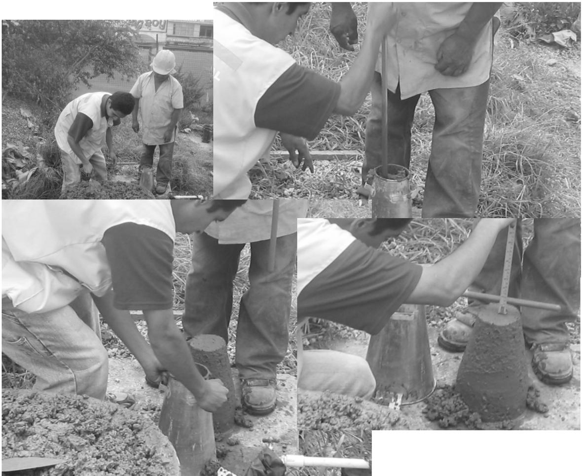
En nuestro medio este ensayo se acostumbra a realizarse solamente cuando se toman los cilindros de muestra para ensayos de resistencia, no obstante se debería realizar cada vez que se produzca concreto: al inicio de la fundición, cada vez que se perciba un cambio considerable de humedad debido a lluvias o exceso
