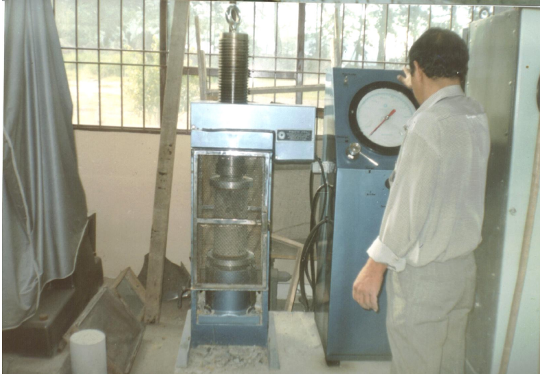
Figura 26. Rompimiento ensayo a compresión.
