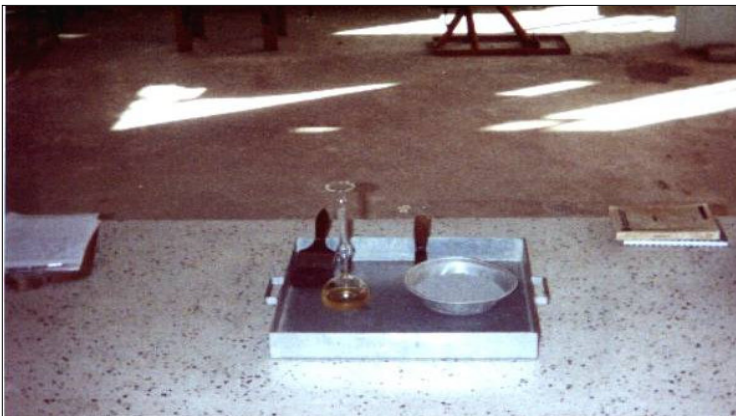
Figura 9. Ensayo de masa unitaria suelta y apisonada.
