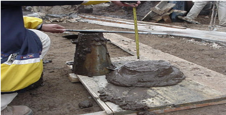
Figura 63. Control de manejabilidad del relleno fluido.
