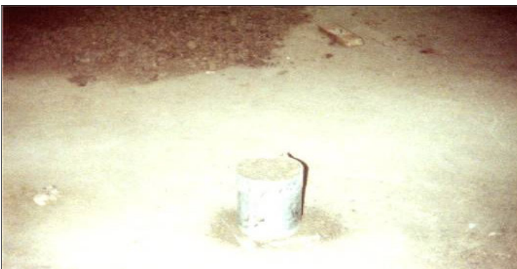
Figura 9. Ensayo de masa unitaria suelta y apisonada.
