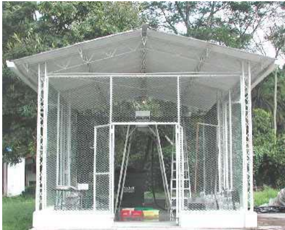
Figura 8. Simulador de lluvia tipo Purdue (Spraying System Company) de aplicación Intermitente
