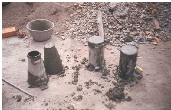
Figura 18. Elaboración de cilindros con la mezcla ensayada con el cono
