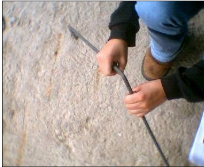
Figura 13. Revisión de fisuras en flejes.
