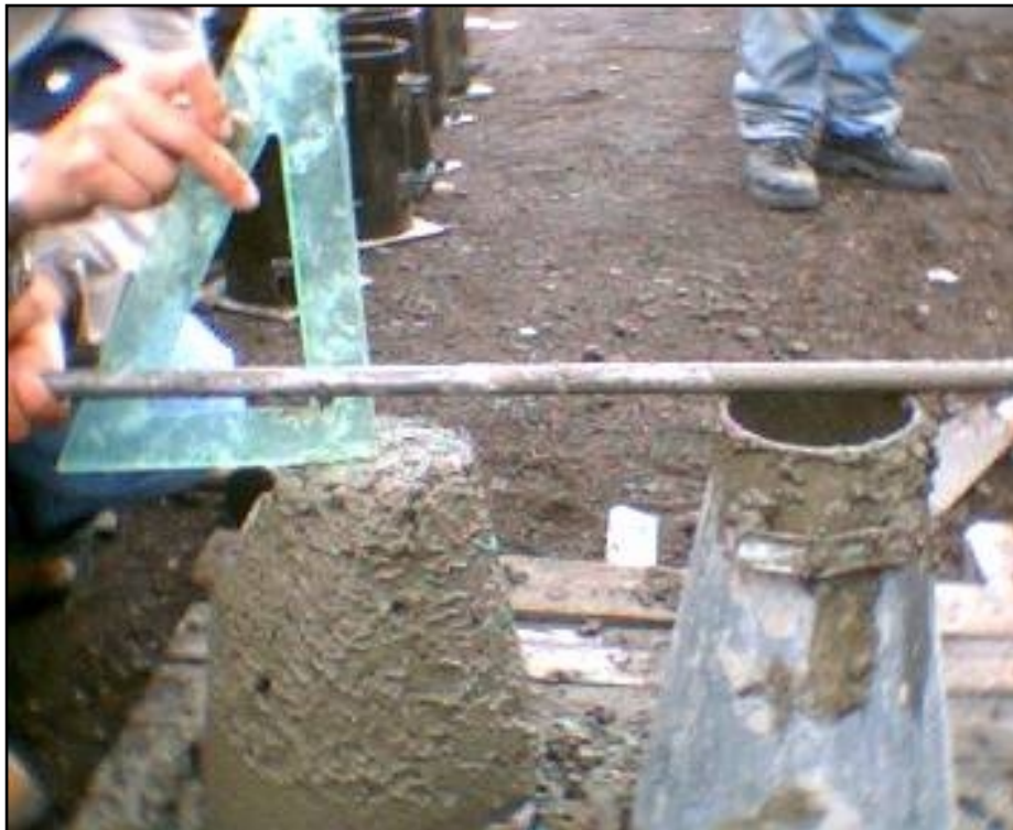
Figura 7. Prueba de cono de Abrams asentamiento de 2”
