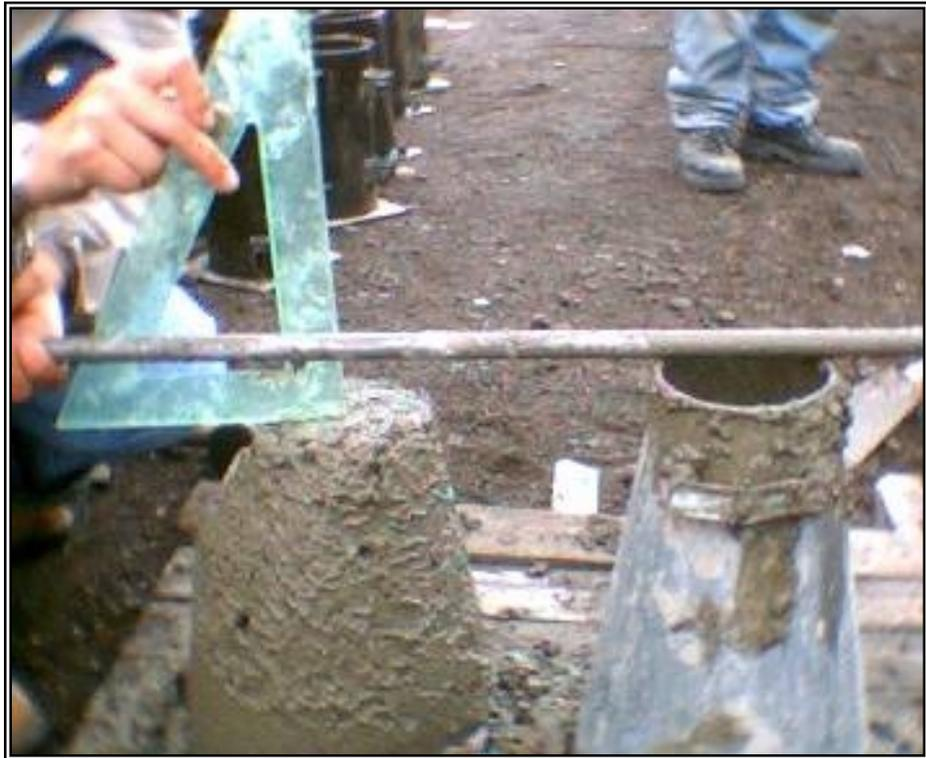
**Figura 84. Prueba de cono de Abrams, al inicio de la fundición**
