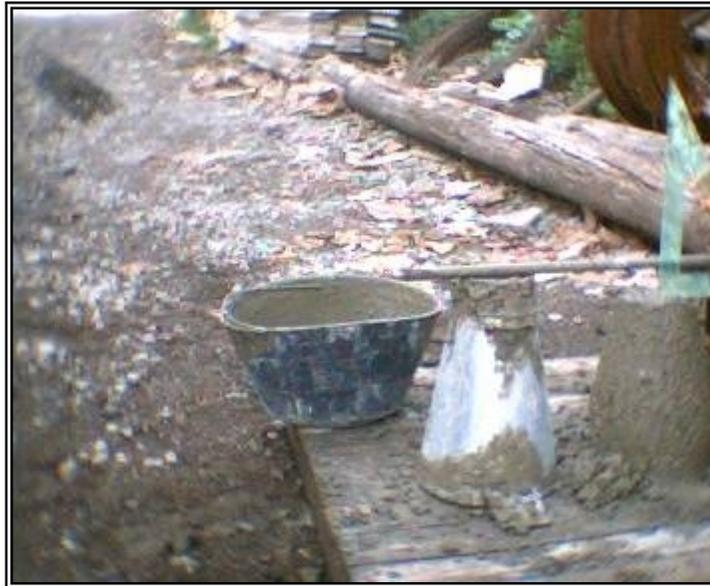
**Figura 55. Control de asentamiento por cono de Abrams, asentamiento 4 cm.**
