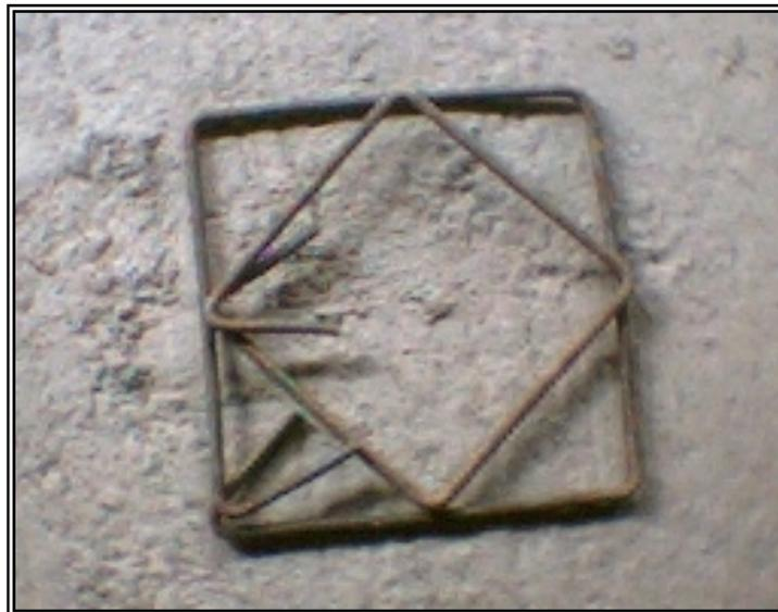
**Figura 6. Flejes para columnas**
