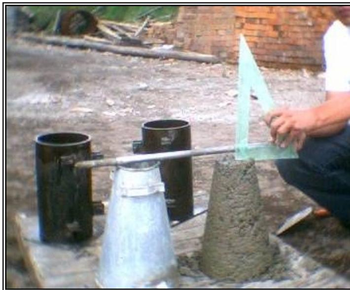
**Figura 23. Prueba de Abrams**
