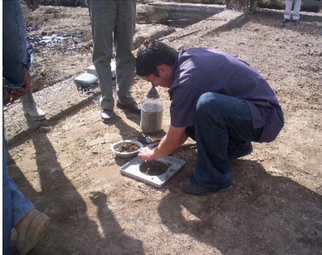
Respecto al material que se utilizó se solicitaron y realizaron los ensayos del material correspondientes a límites, granulometría y el Proctor Modificado; con el fin de poder realizar el control de compactación en obra con la toma de densidades.
