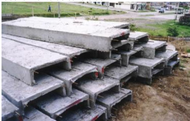
Figura 24. Almacenamiento de canaletas
