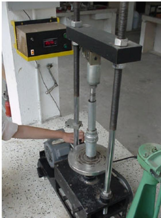
La muestra se retira del molde con ayuda de una palanca de forma manual (figura 11 y 12).
