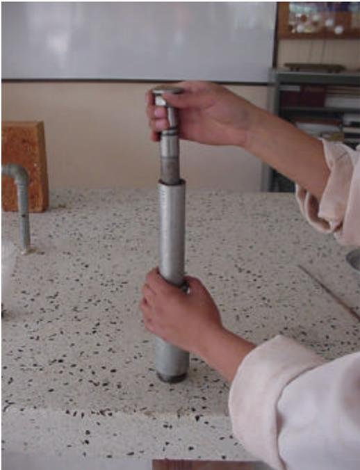
El molde se llevó a la plataforma de la prensa digital y se colocó centrándolo respecto a la rotula de la máquina y se le aplicó una carga de 2000 lb (carga determinada mediante preensayos realizados con el fin de extraer al máximo los vacíos que pueden quedar en la muestra después de compactada) (figura 10).
