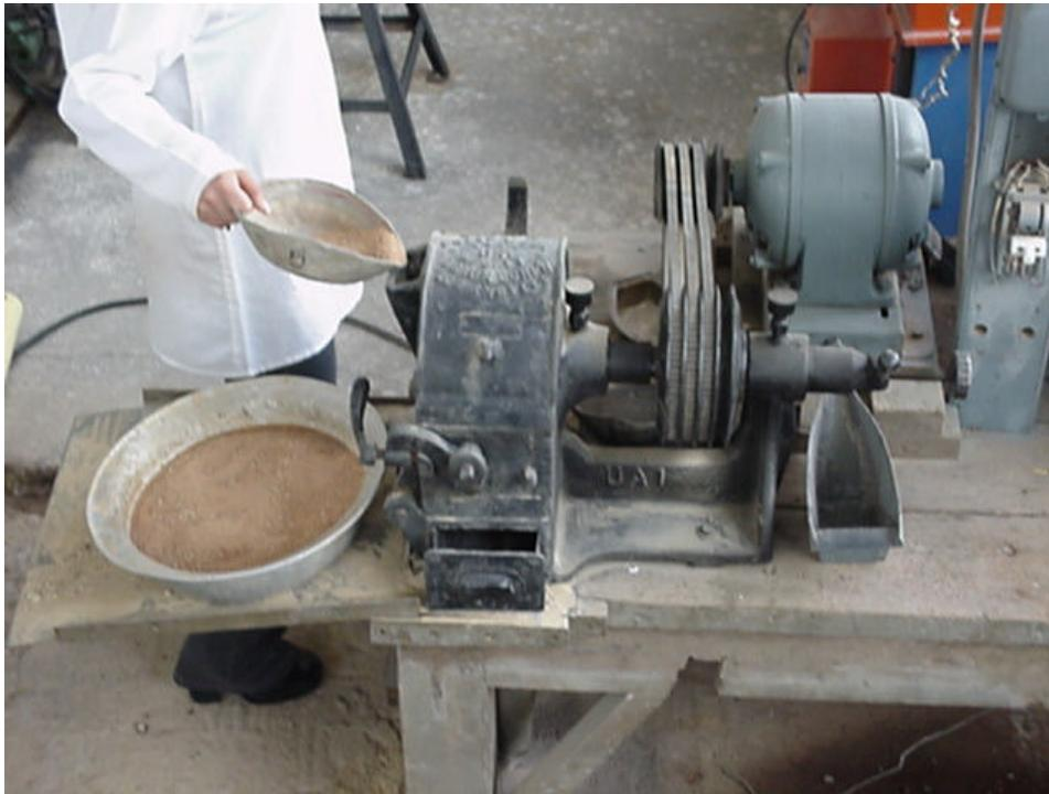
**Figura 3. Molino de bolas (vidrio reciclado)**
