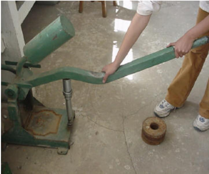
**Figura 12. Extracción de la probeta**
