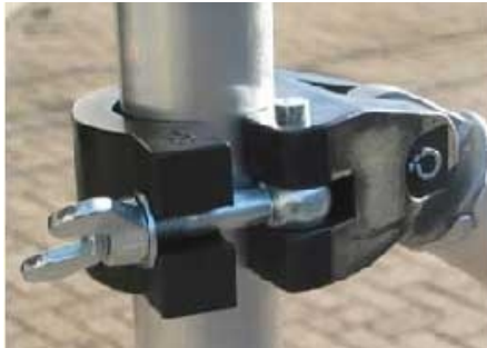
Figura 49: Sistema tipo abrazadera con ajuste .
