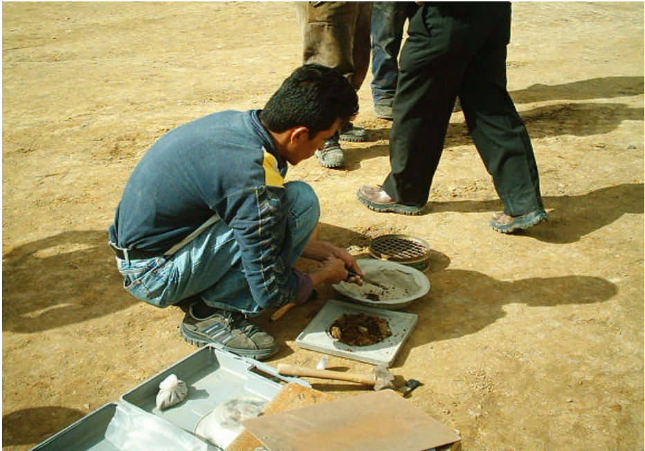
Figura 19. Ensayo de densidades in situ
